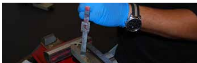
La délicate opération du grattage manuel.
