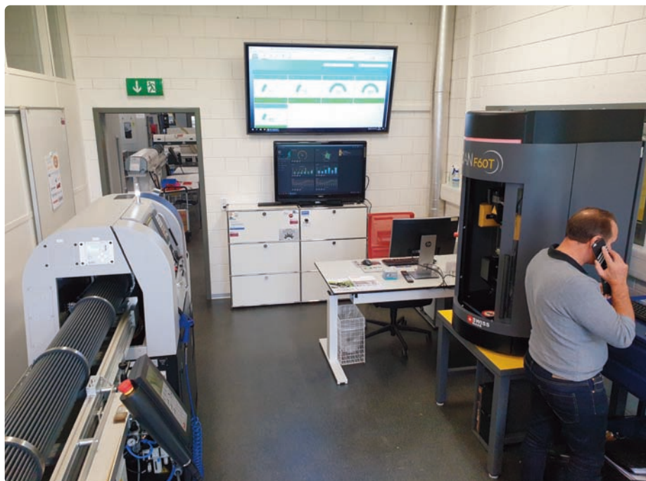
Les ateliers du Centre technique et de formation de l'industrie suisse du décolletage et du taillage (CIP-CTDT) sont équipés de décolleteuses à cames, de tours automatiques à commande numérique, de tours et centres d'usinage modernes et de machines à tailler.
